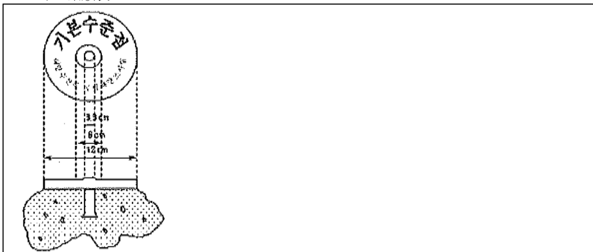
カ. 基本水準点標識(単位：センチメートル)
