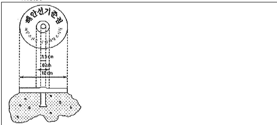
ク. 領海基準点標識(単位:センチメートル) 1) 銅版製
